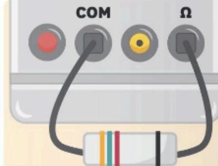
Mesure de la résistance avec l'ohmmètre
