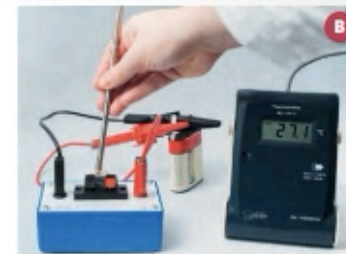
Doc. 3 Mesure de la température d'un résistor avant (A) et après (B) quelques minutes de circulation du courant électrique.
