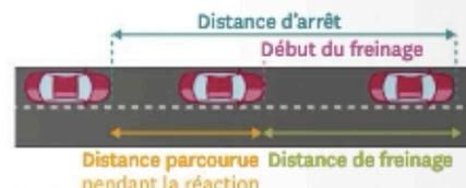
Doc. 2 Distance d'arrêt d'un véhicule.
