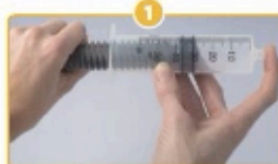
Doc. 4 Étude d'un gaz : la seringue reste hermétiquement fermée d'une image à l'autre.
