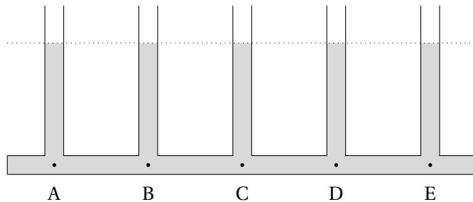
Rempli avec de l'eau, les niveaux dans les tubes verticaux sont tous sur la même horizontale d'après les lois de statique des fluides.
